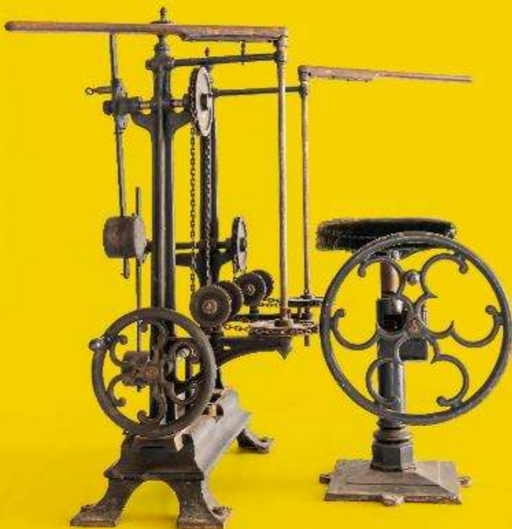
Medico-mechanische oefenmachine ontwikkeld door de Zweedse arts Gustaf Zander, ca. 1890-1900. Dit toestel voor het trainen van de armspieren is afkomstig uit de Gentse kliniek Vercauteren, waar veel slachtoffers van arbeidsongevallen behandeld werden. De plek kreeg in de volksmond de veelzeggende bijnaam 'het slachthuis'. Collectie Industriemuseum
